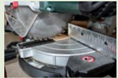
Das Holzstück wird von der Oberseite angelegt und auf die gewünschte Länge mit der Kappsäge zugesägt.
